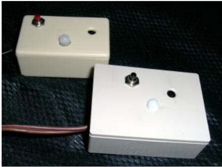
この装置はP I C 12F675 のA/Dコンバータを使用し電圧を読み取る仕組みです。あまり精度はよくありませんが、バッテリーの状態を監視するには十分だと思います。基準電圧はP I C のV d dを使用し、抵抗とV Rによる分圧で7 V～1 6 V程度を測定範囲としています。
